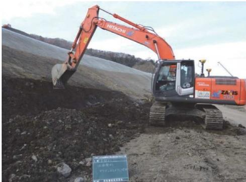
写真-1 バックホウマシンガイダンス
