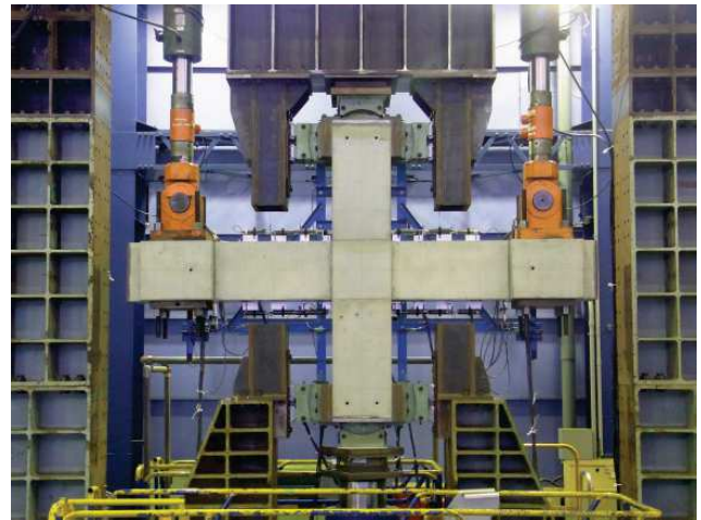
図-1 十字形接合部正負繰返し静的載荷実験
