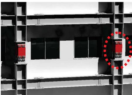
図-1 BiD フレーム工法Dタイプ概要
