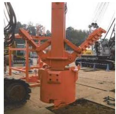
図-2 下部掘削バケット
