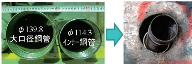
写真-1 2重管構造
