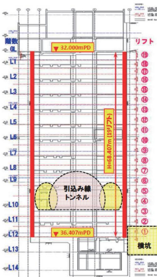
図-6 立坑断面図
