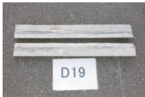
写真－10 モルタルの充填状況 (例)
