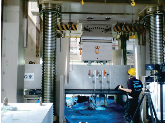
写真-3 せん断試験状況
