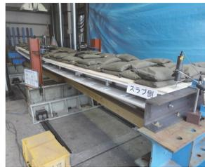
写真-2 2500 N/m<sup>2</sup> 載荷時
