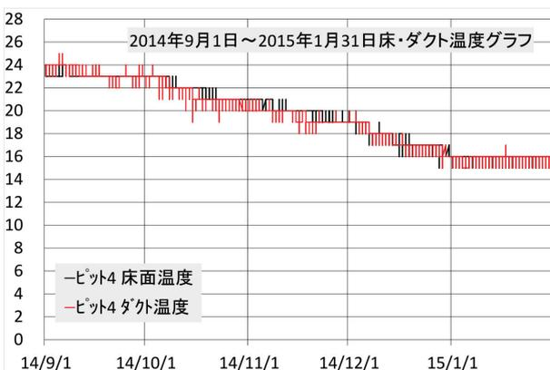
図-25 ピット4床面・ダクト温度
