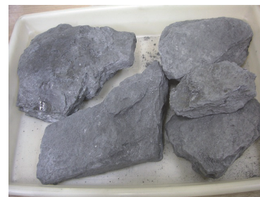
写真-1 岩石試料（三波川結晶片岩類黒色片岩）
