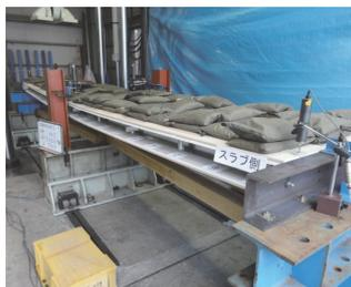
写真-1 2500 N/m<sup>2</sup> 載荷時
