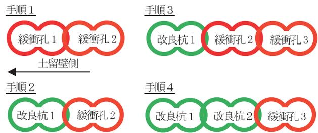
図-3 緩衝孔を伴う改良の施工手順
