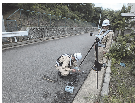
写真－５ 振動測定状況写真
