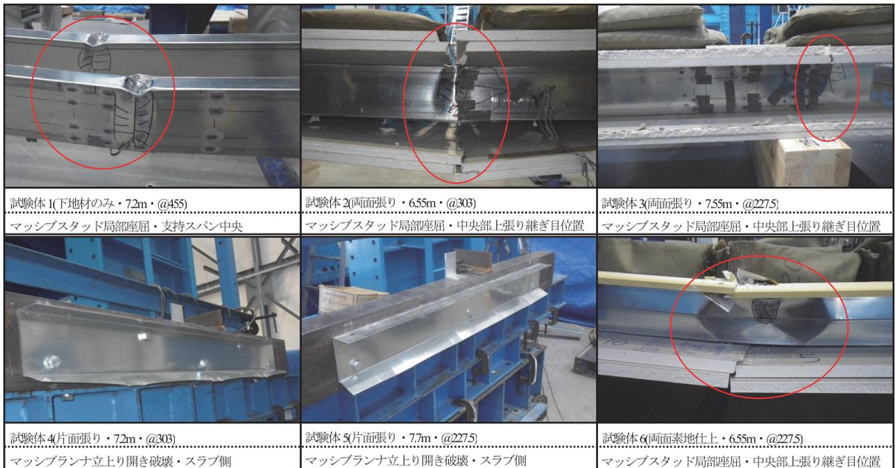
写真-2 各試験体の破壊性状
