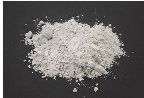
写真-1 鉄鋼副産物「高炉スラグ微粉末」
