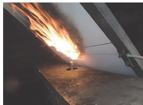
写真-6 延焼性試験の状況
