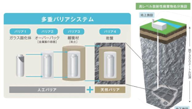
図-1 高レベル放射性廃棄物処分の基本的なバリア構成<sup>2)</sup>
