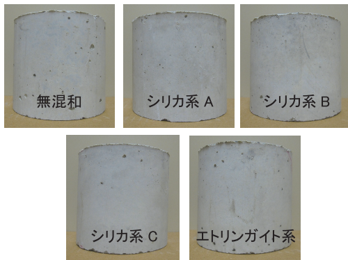
写真-2 硬化体の外観色調 (材齢 1年)
