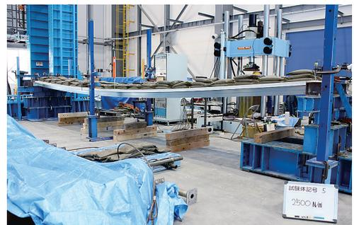
写真-1 2500 N/m<sup>2</sup> 載荷時
