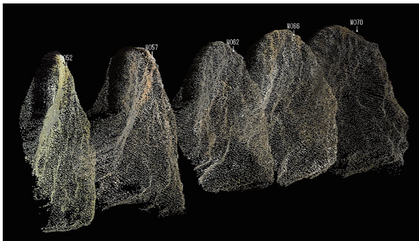
図-11 切羽写真の3次元表示例
