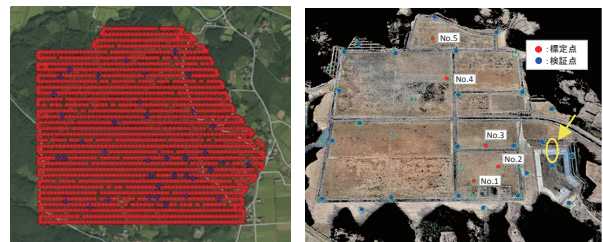
図-2 自動飛行による撮影位置、点群データ (郡山市 郡山西部第一工業団地)
