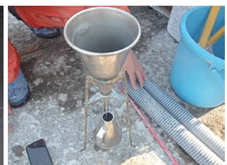
写真-3 ファンネル粘性試験
