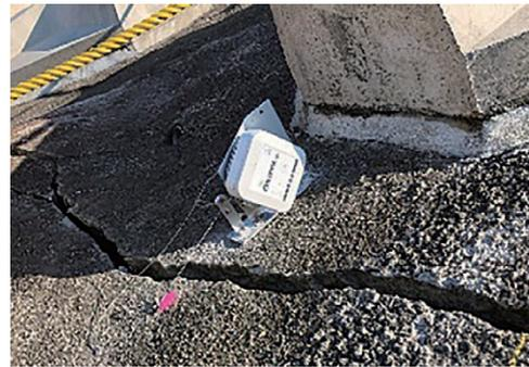
写真-3 OKIPPA 伸縮計の確認試験状況
