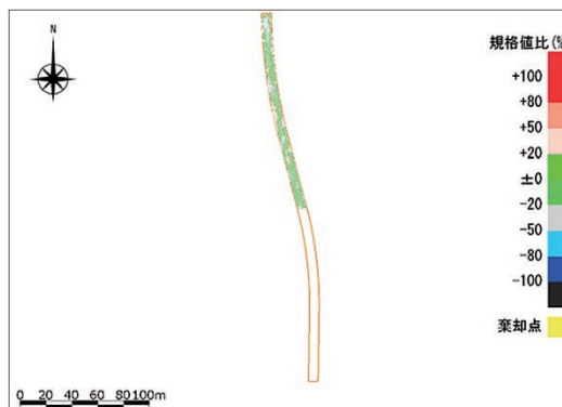
図一十 上層路盤工の出来形測量結果
