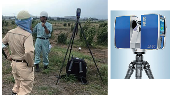
写真一 3D レーザースキャナ測量状況
