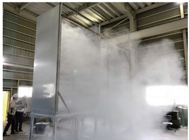
写真-1 加湿装置 （上：噴霧ノズル設置状況，下：噴霧試験状況）
