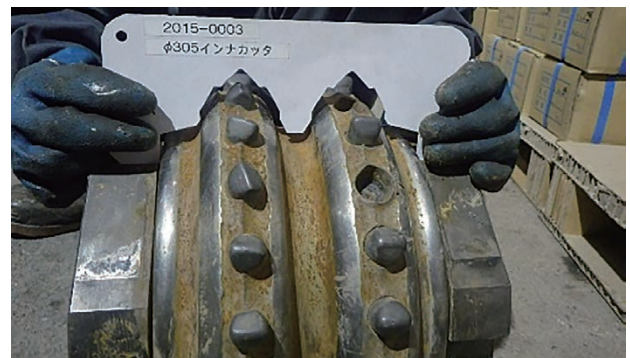
写真-2 超硬チップ欠損状況
