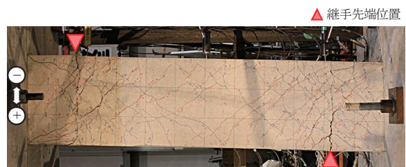
写真一 1 最終破壊状況 (SB2)
