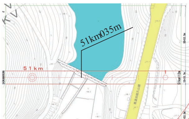
図-2 トンネルと堰堤の位置関係平面図
