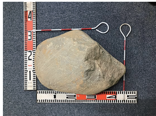
写真一六 機内配管より採取した礫(砂岩)
