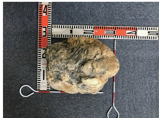
写真一七 機内配管より採取した礫(チャート)
