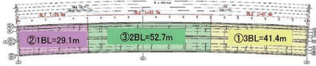
図-9 打設ブロック割付図
