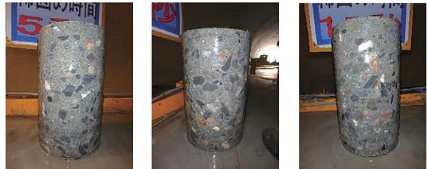
写真二 気泡間隔係数測定用コア供試体
