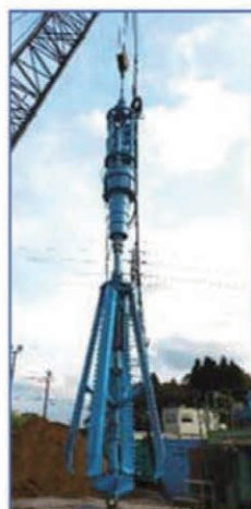
JSHR拡底掘削機 (拡翼時)
