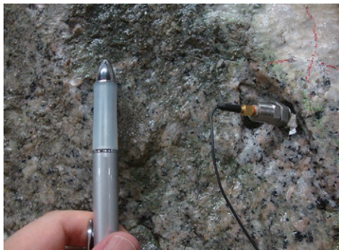
写真一11 ネジ締めで岩着した加速度計（受信点③）
