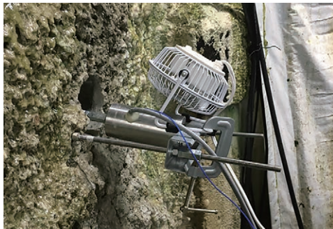
写真一10 岩盤に設置した超磁歪材発振子
