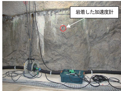
写真-8 アクセス南坑道西側壁に設置した受信点②
