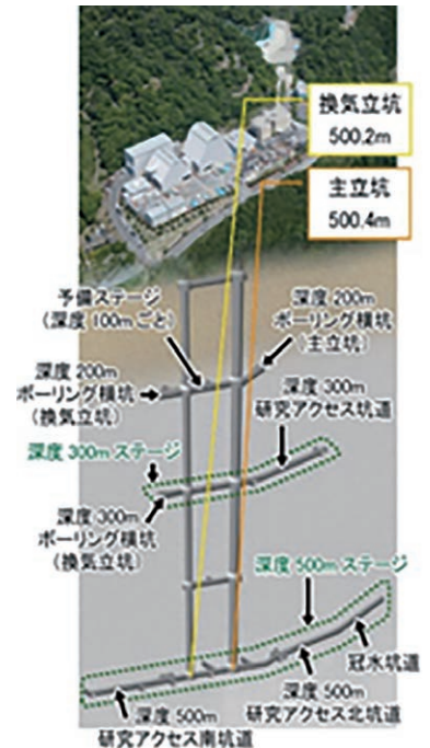
図一1 瑞浪超深地層研究所研究坑道レイアウト 1)
