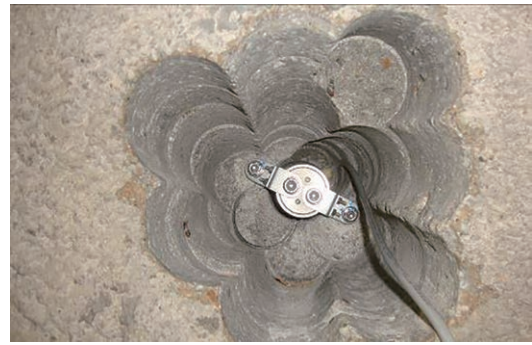
写真一5 岩盤に設置した超磁歪材発振子
