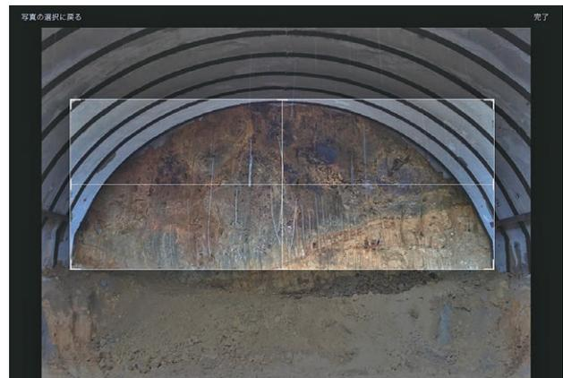
図-7 切羽面の抽出 (枠の位置や大きさを操作)
