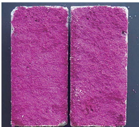
図-5 中性化測定結果 (PS10: 土中養生)
