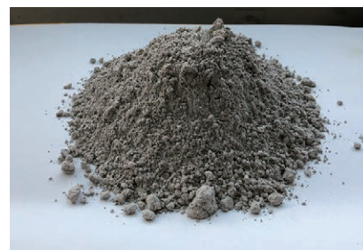
写真-4 PS 灰の外観
