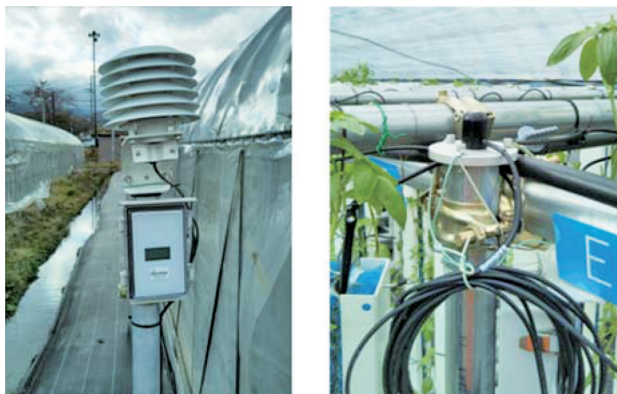
写真一 本システムの設置状況 (左：ハウス外の温度、右：ハウス内の日射量)
