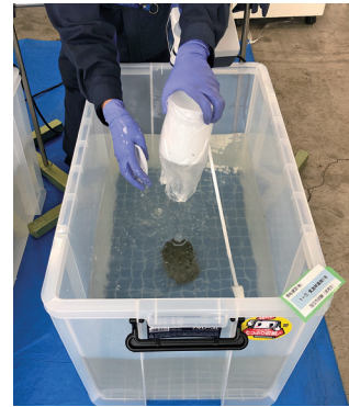
図-1 試料の投入状況 (泡立ち試験)
