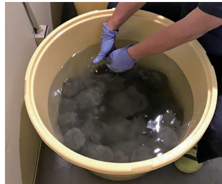
図-2 試料の投入状況 (陰イオン界面活性剤の溶出試験)
