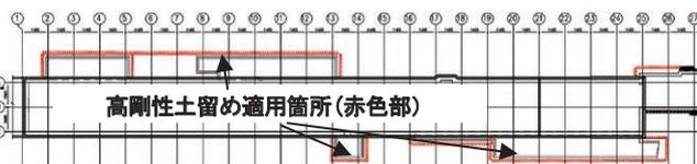
図-1 高剛性土留め壁適用箇所
