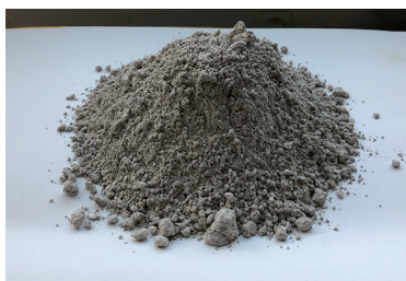
写真-2 PS 灰の外観
