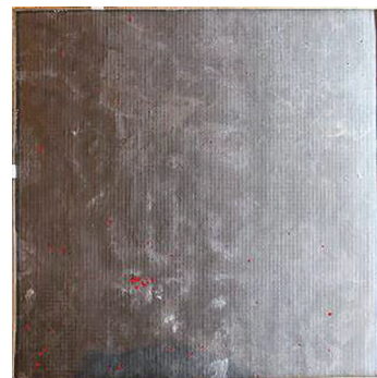
写真一5 気泡発生状況（C部）
