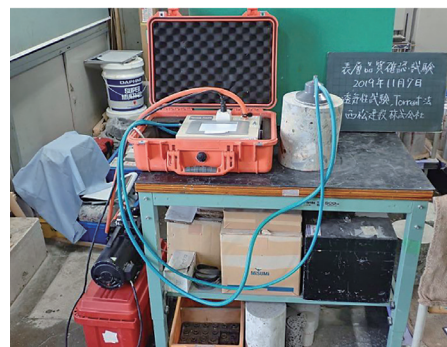
写真一6 表層透気試験実施状況
