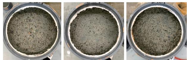
写真-7 スケーリング試験面 (50 サイクル)
