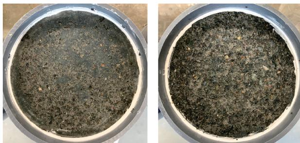
写真-6 スケーリング試験面の損傷例
