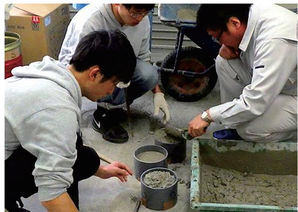
写真一2 スケーリング試験用供試体の採取状況
