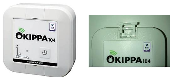
写真-1 センサボックスの外観と固定用ビス穴
