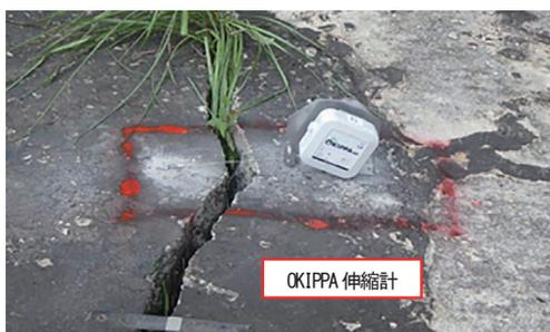
写真—8 張りコンクリートのクラック計測事例
