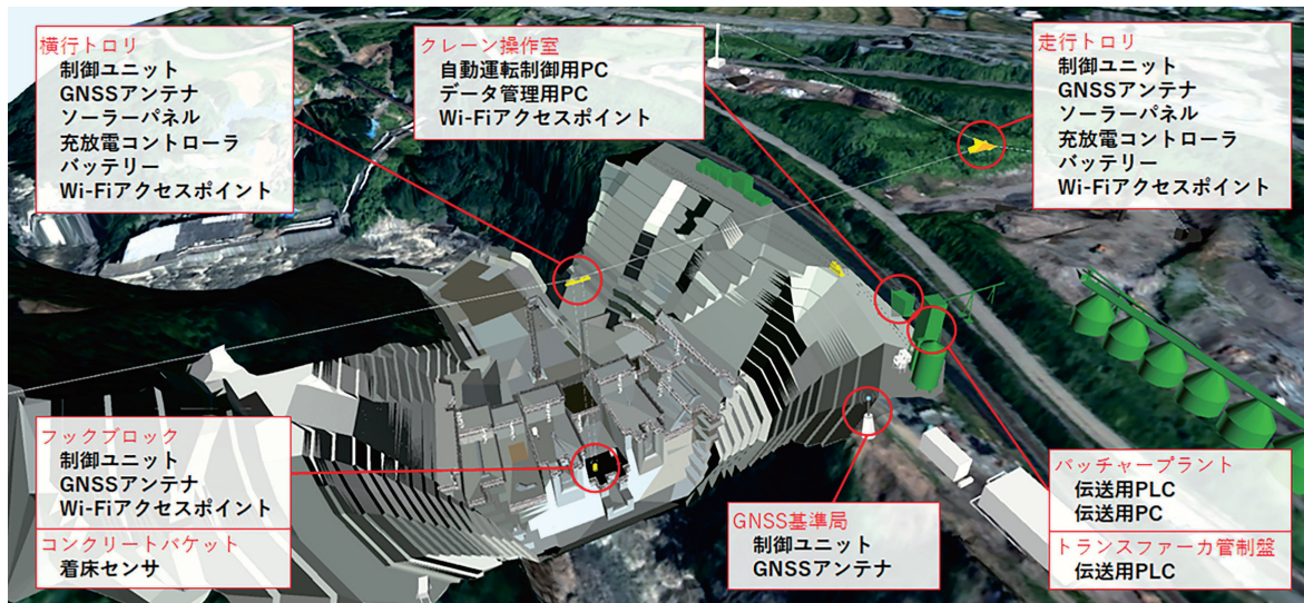
図-3 使用機器と設置個所
