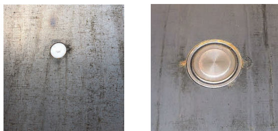
写真一9 セントルフォーム面に設置したセンサー
