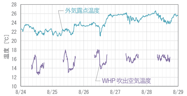
図一15 夏期代表週の外気露点温度とWHP吹出空気温度
