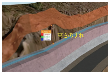
図-3 切土補強土壁の現況地盤との不整合
