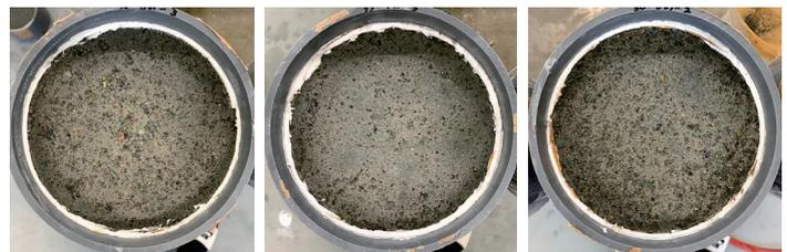
写真二 スケーリング試験体の試験面 (50 サイクル)
