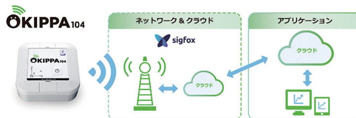
図一 傾斜監視クラウドシステム OKIPPA のイメージ
