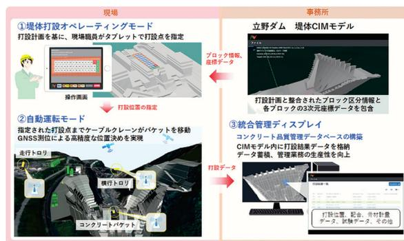
図一 ケーブルクレーン自動運転システムの概要
