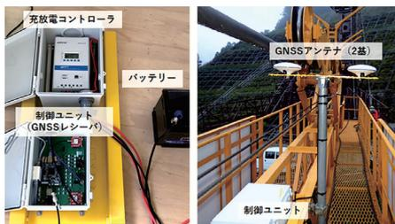
写真一 GNSS 受信装置
