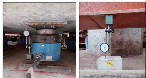
写真-6 ダイヤルゲージによる変位計測
