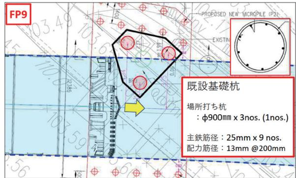
図-7 基礎杭切削撤去 (FP9)
