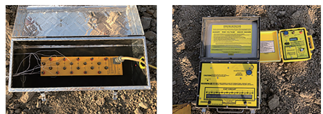
写真-3 DS 多段式電気雷管の発破制御器
